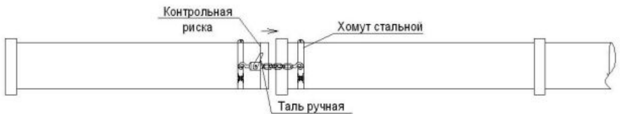
Рисунок 8 – Наружная стыковка труб с помощью тали.
